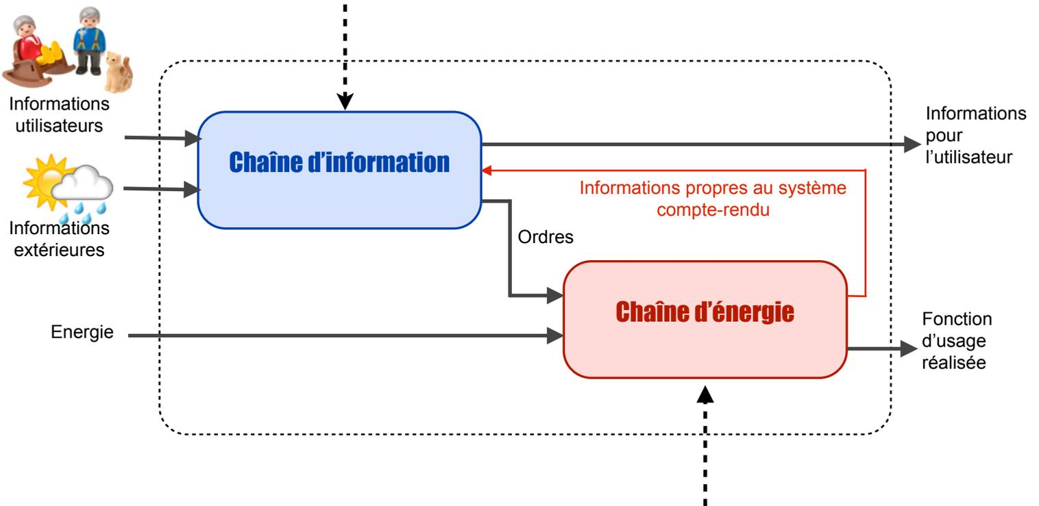
**La chaîne d'énergie** : C'est la partie qui **transforme l'énergie** pour obtenir l'action voulue, en exécutant les ordres reçus. C'est souvent la partie la plus visible du système.
