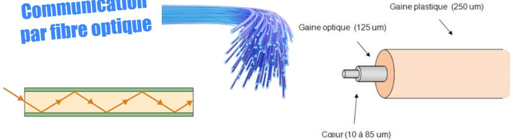
Constituée de faisceaux de fibres de verre parcourus par des signaux lumineux. Elle permet des communications à très longue distance et à des débits jusqu'alors impossibles : à la vitesse de la lumière ! C'est la révolution des télécommunications !
